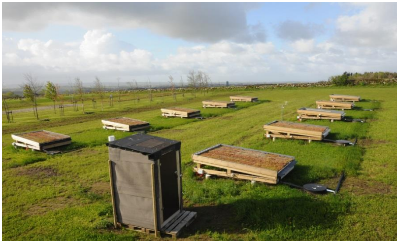
Bilde 2. Forsøkstak etablert på Jæren for måling av retensjon og avrenning ved forskjellig oppbygning av takene. Vann fra hvert tak samles opp i nedgravde dunker der en trykksensor gir informasjon om avrenning.
