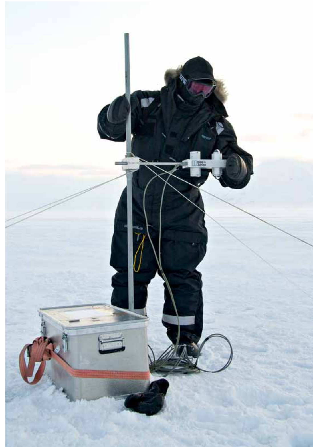
Målinger av albedo, inkommende og reflektert solstråling, i Adventdalen. Foto: Erik W. Kolstad
