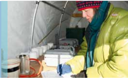
Mary Albert, fra Dartmouth College i USA, måler varmeledningsevnen i iskjerner i laboratorieteltet. Foto: Stein Tronstad
