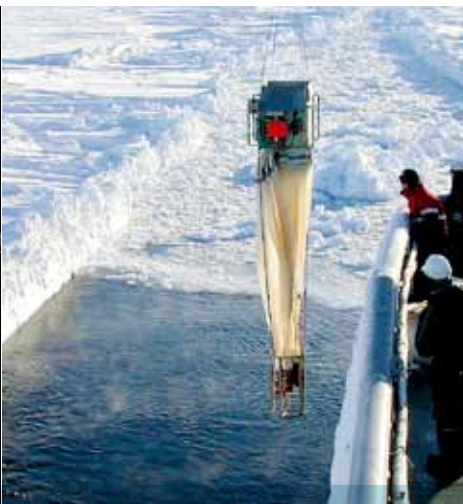
Innsamling av dyreplankton med multinett i Øst-Grønlands isen fra KV Svalbard. Noen ganger var det så vidt nok åpent vann til at vi fikk instrumentene i sjøen. Foto: Camilla Svensen
