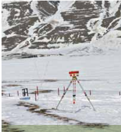
Her måler teamet ved UNIS bevegelser i permafrosten ved tining og innfrysing. Fra Endalen på Svalbard. Foto: Kristen Ulstein
