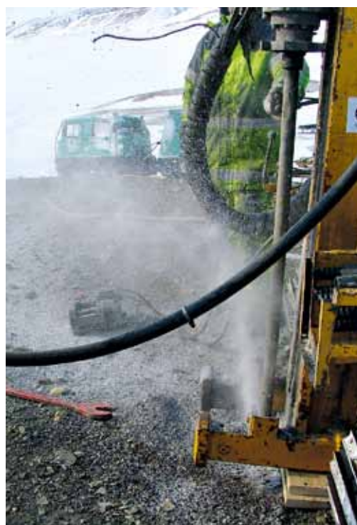
Hammerdrill-riggen brukes til å bore i en isrik pingo på Svalbard. Foto: Hanne H. Christiansen
