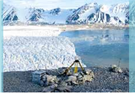
Time-lapse-kameraer ble brukt til å overvåke isflyt og kalving på Kronebreen, Svalbard. Foto: Jon Ove Hagen
