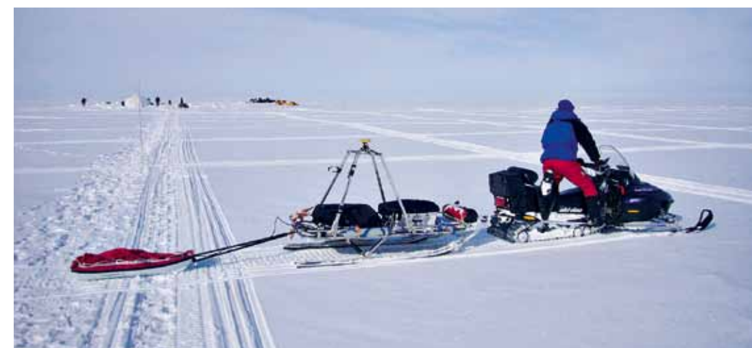
Snøradar og GPS-høydeprofilering på toppen av iskappen Austfonna. Foto: Jon Ove Hagen
