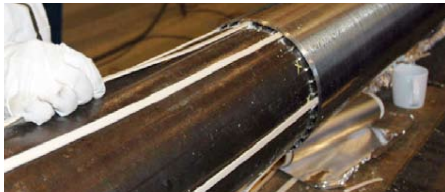
STRIPS: Bildet viser hvordan RESMANs trådløse system settes inn i en type sandskjerm. Det er forskjellige metoder for forskjellige rør. Foto: RESMAN
