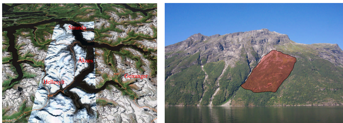
Fig. 1. Åknes ligger i fjordsystemet Storfjorden midtveis mellom Stranda og Hellesylt (venstre bilde). Volumet av den ustabile fjellsiden (farget rødt i høyre bilde) er anslått til 40-70 millioner kubikkmeter.
