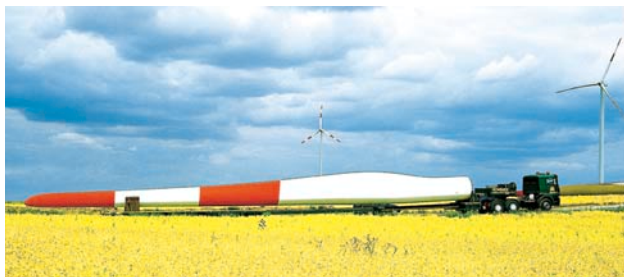
Denne 35 meter lange vingen ble montert på en 1,5 MW vindmølle i Sachsen-Anhalt, Tyskland. Foto: Herbert Grabe, OSTWIND
