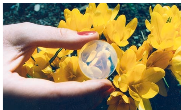
Monolittisk aerogel produsert ved NTNU i Trondheim.
