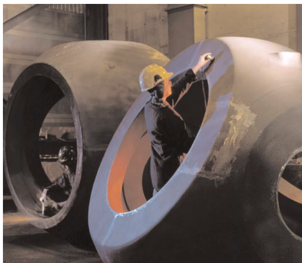
Støping av seigjernprodukter på Kristiansand Jernstøperi
