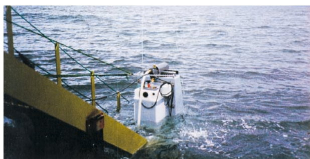
Bølgekraftmodell i skala 1:6 ("ConWEC") En flottør på en svingende vannsøyle driver et stempel til å pumpe sjøvann.
