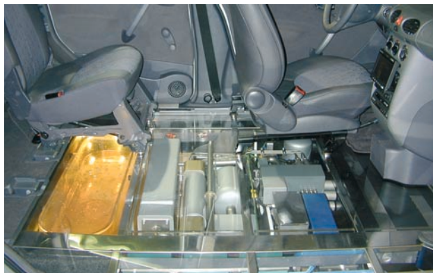
NECAR 5 brenselcellebil fra DaimlerChrysler. Metanoltank, reformer, prosessutstyr og PEM-brenselcellestak befinner seg i understellet av bilen.
