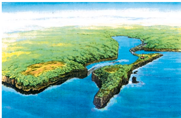
Kilerennekraftverk som er planlagt bygd av det norske selskapet Indonor A.S. på sørkysten av Java (etter Norwave A.S. sitt konsept "Tapchan"). Bølgene samles i en "kollektor" inn mot en horisontal kilerenne, der sjøvann blir løftet 4 m opp i et basseng, som forsyner en lavtrykks Kaplan-turbin.
